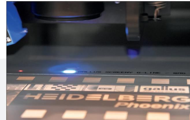
Der automatische prädiktive Autofokus ist ein Highlight des Phoenix CtS-Systems. Das Autofokussystem misst permanent den Abstand zwischen Belichtungskopf und Bildwandfläche und stellt sich automatisch in Z-Richtung auf eine konstante Schärfentiefe während der Belichtung ein - für perfekte Qualität.
