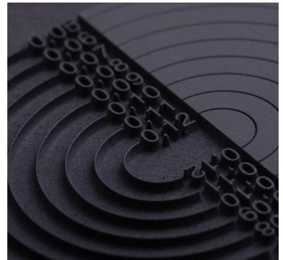
DROP Lösung für den Flexodruck - DirectPoser und die DROP EPDM Flexodruckplatte gelasert mit 5080 dpi.
